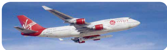
圖4：小型衛星透過「宇宙女孩」波音747從高空發射。
