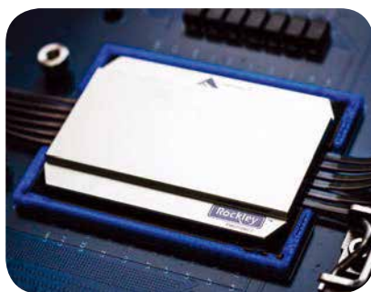
圖5：Rockley Photonics在OFC2018上展示了其Topanga 12埠100G乙太網路交換機。(圖片來源：Rockley Photonics)
