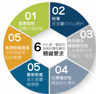
圖3：RDL第一製程的耗蝕性釋放層的關鍵要求。
